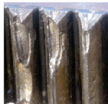
图四 有 37^\circ 斜角的断齿图
