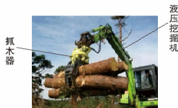
图1 液压挖掘机抓木器作业
